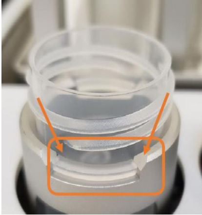
图 6. 反应管叶片应正确放入离心管托架中
