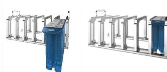
图 4. 试剂盒 (试剂和磁珠) 滑入试剂盒托架底部后会听到一声咔哒声
