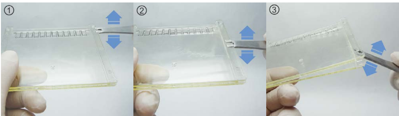
图 6. 打开胶板取出凝胶
